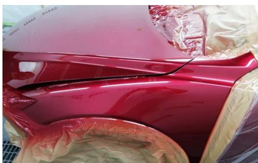
On formulera la couleur de la première couche avec une dilution entre 70 et 80%. On appliquera la première couche fine de contact ou d'ancrage.
